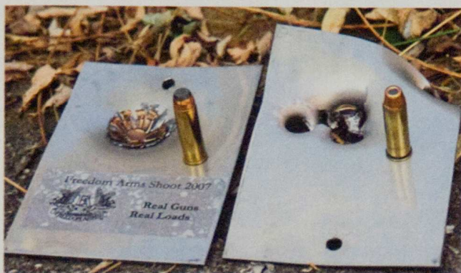
Die 2-mm-Stahlbleche: von Serienmunition in .44 Magnum nur eingedellt (links), die Silhouetten-Ladung marschierte durch!
